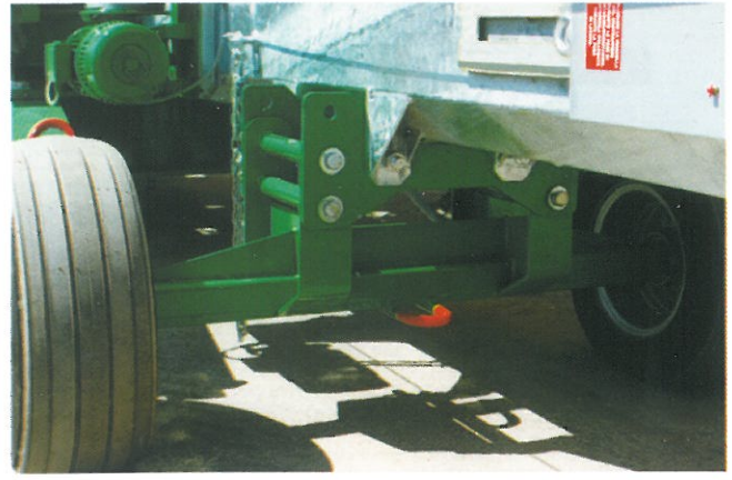
INNESTO ASSALI CON ALTEZZA VARIABILE AXLES COUPLING WITH VARIABLE HEIGHT
