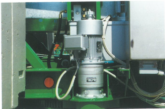
ROTAZIONE ELETTRONICA IN PRESA DIRETTA DIRECT DRIVE ELECTRONIC SLEWING
